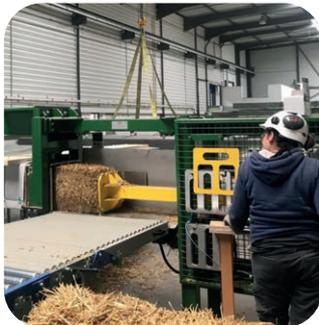
La MANUFACTURE BOIS PAILLE conçoit, fabrique et commercialise des murs en ossature bois isolés avec des bottes de paille et des matériaux biosourcés localement, durables et performants.
